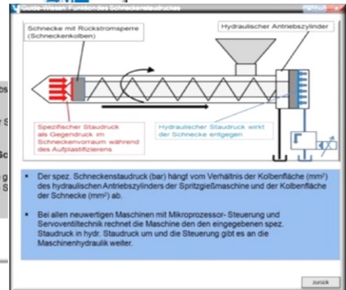
Bilder: Guide-Wissen am Beispiel der Funktion des Schneckenstaudruckes
